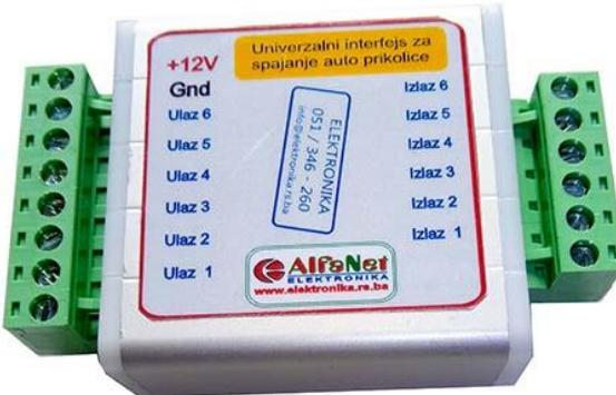
Na nove automobile ne možete priključiti instalaciju prikolice tako jednostavno kao što se to nekada radilo - paralelno postojećim sijalicama na automobilu! U savremenim automobilima kompjuter mjeri potrošnju svake sijalice i u slučaju prevelike struje, taj izlaz gasi. Ako sijalicu od prikolice spojite paralelno postojećoj u automobilu struja će biti prevelika i rezultat je isti... izlaz se gasi i ne radi ni jedna!
